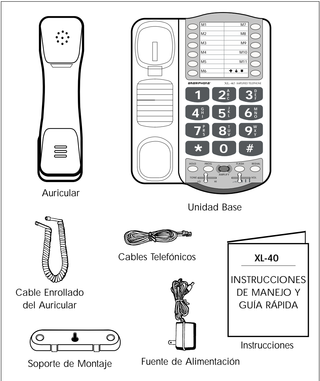
Figura 1 - Control del Contenido
